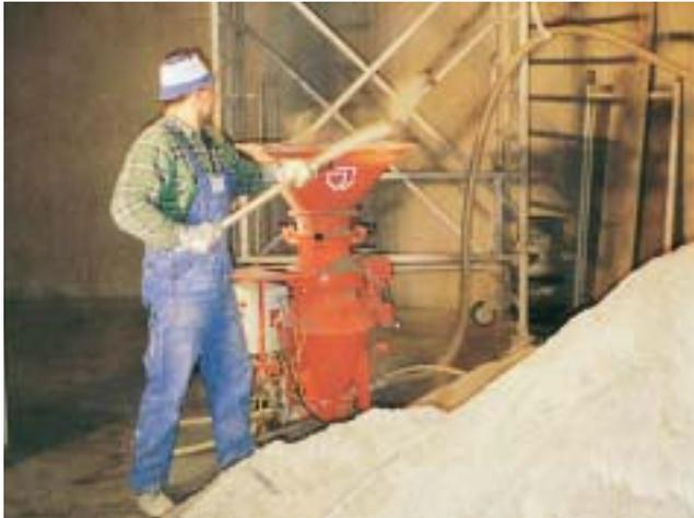
Mit Hilfe des PFT SILOMAT Typ EUMAX konnte der abgestrahlte Mörtel und die verwendete Sandstrahlschlacke problemlos, zügig und ohne großen Kraftaufwand nach oben in die bereitstehenden Müllmulden befördert werden. Der anstehenden Neubeschichtung stand somit sprichwörtlich nichts mehr im Weg.
